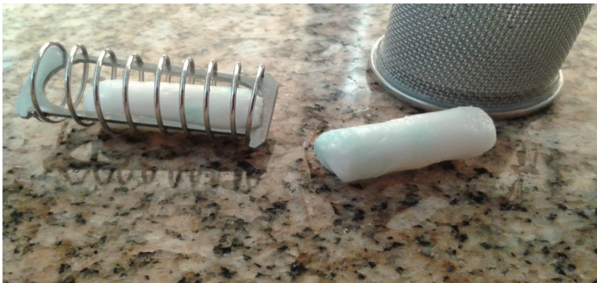
Figura 13- Apresentação da formação de grumo com aspecto gelatinoso a partir de formulações contendo roxitromicina 300mg em solução tampão utilizando-se diferentes aparatos.
