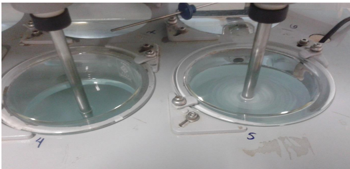
Figura 15 - Dissolução de roxitromicina cápsulas 300 mg em tampão fosfato pH 6,0 (esquerda) e água purificada (direita).
