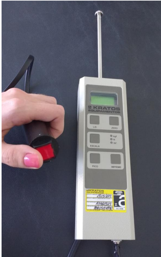
Figura 5 - Algômetro DDK/20 - Kratos ® utilizado para a obtenção do limiar de dor por pressão. Fonte: Do autor.
