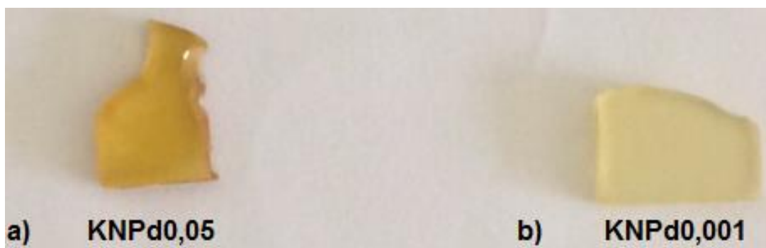
Figura 27 - Vidros obtidos com diferentes concentrações de sais de paládio; a) amostra com 0,5% de \text{PdCl}_2 ; b) amostra com 0,001% de \text{PdCl}_2 .
