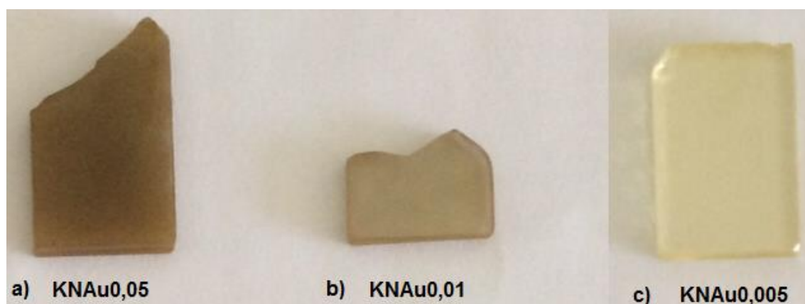
Figura 45 - Vidros obtidos com diferentes concentrações de sais de ouro; a) amostra com 0,05% de \text{Au}_2\text{O}_3 ; b) amostra com 0,1% de \text{Au}_2\text{O}_3 ; c) amostra com 0,005% de \text{Au}_2\text{O}_3 .
