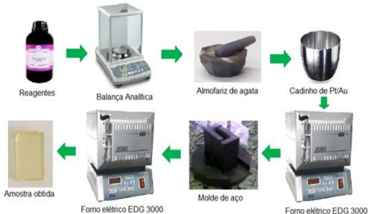
Figura 13 - Etapas do processo de conformação de vidros
