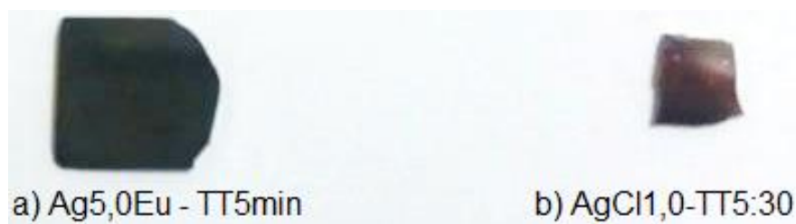
Figura 42 - Amostras vítreas dopadas com \text{AgNO}_3 e \text{AgCl} tratadas a 650^\circ\text{C} com diferentes intervalos de tempo. a) amostra \text{Ag5,0Eu} tratada por 5 minutos.; b) amostra \text{AgCl1,0} tratada por 5:30h.
