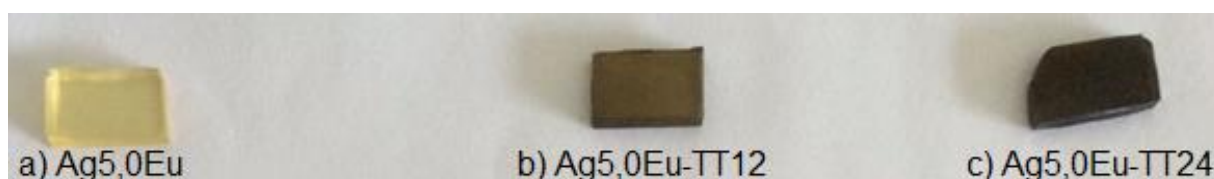
Figura 32 - Amostras com 5% de nitrato de prata em diferentes tempos de tratamento. a) sem tratamento térmico; b) 12 h tratamento; c) 24 h de tratamento.
