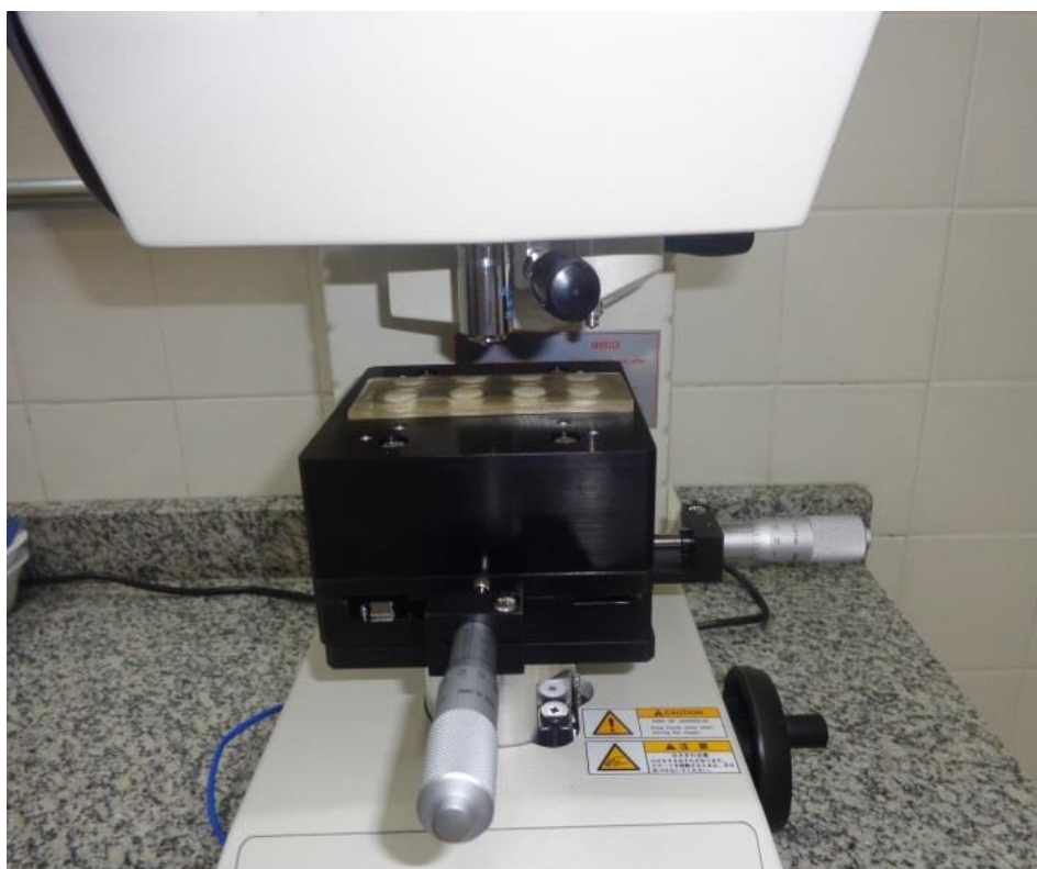
Figura 14 - Corpos de prova posicionados para o teste de microdureza
