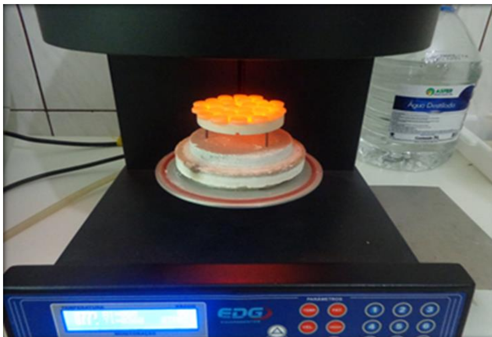
Figura 8 - Corpos de prova sendo queimados à temperatura inicial de 360°C
