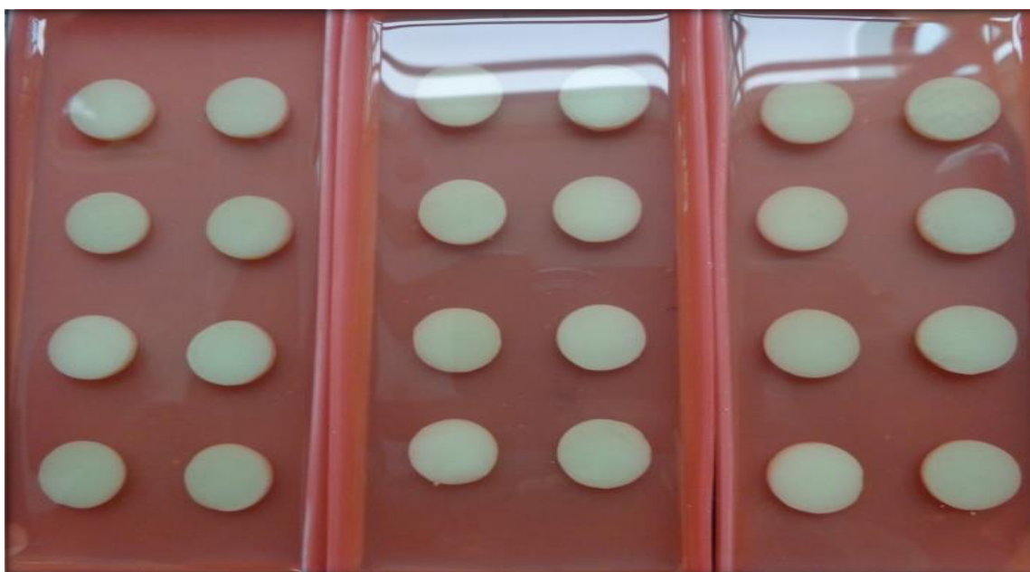
Figura 12 - Corpos de prova dispostos em caixas de cera 7 incluídos com resina líquida
