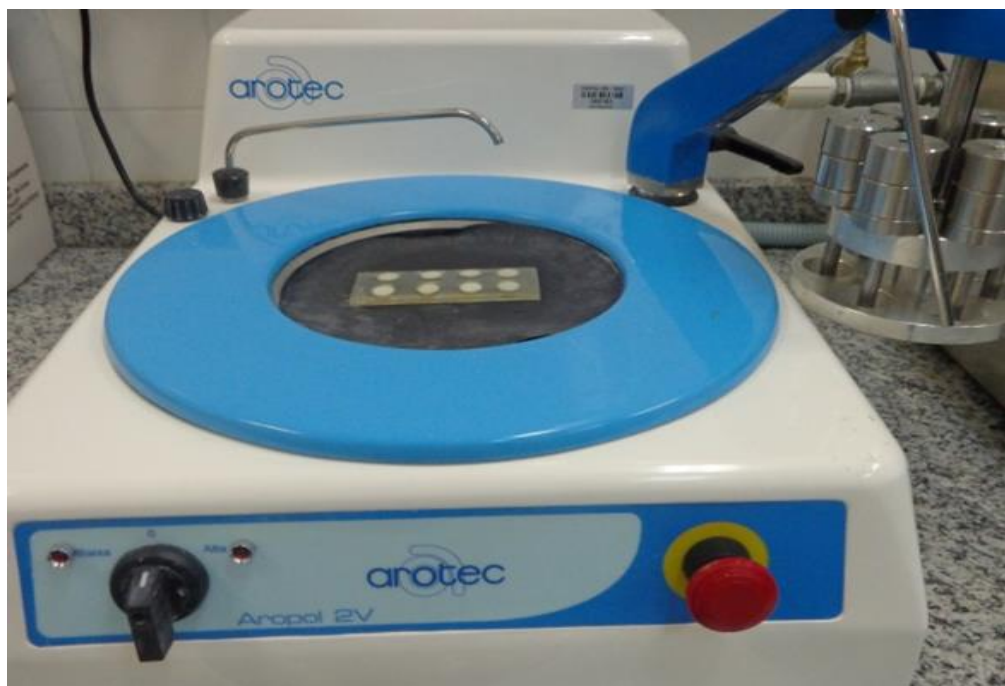
Figura 13 - Planificação e polimento das placas de resina em politriz metalográfica
