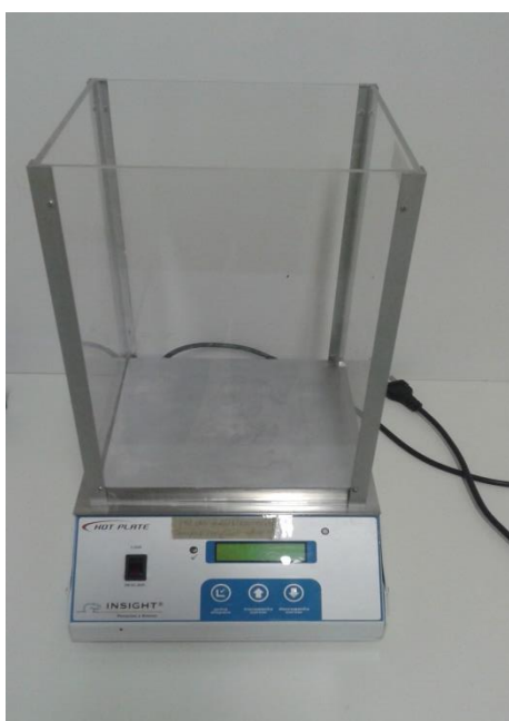
Figura 6- Aparato utilizado para o teste da hiperalgesia térmica: placa quente.
