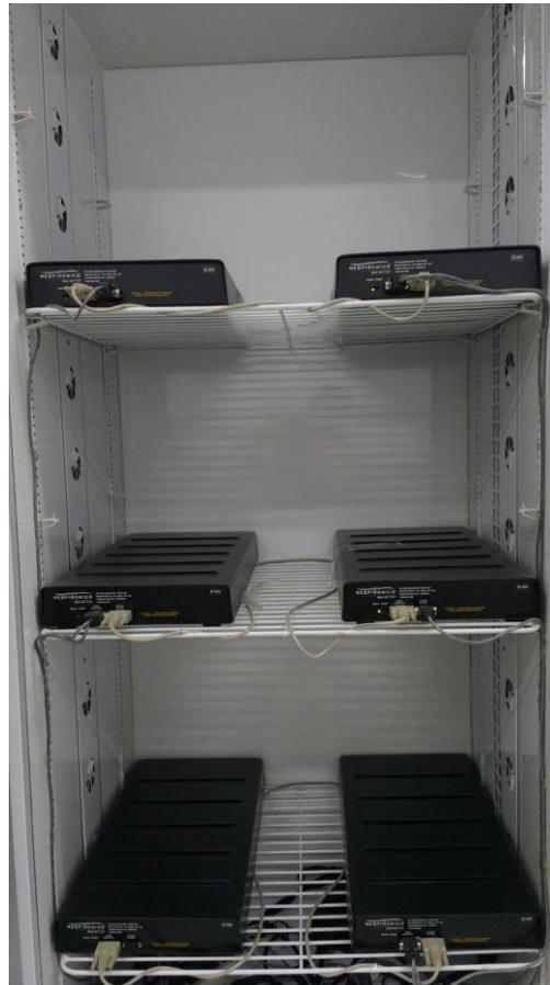
Figura 7 - Receptor de telemetria (*Data Science*) conectado ao computador.
