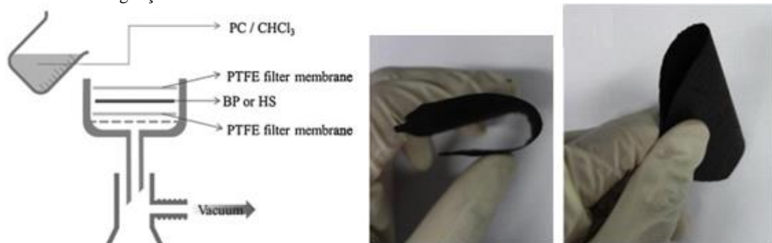
Figura 6 - Preparo de buckypaper por filtração da mistura CNT e solução dispersante previamente tratada com agitação e ultrassom.
