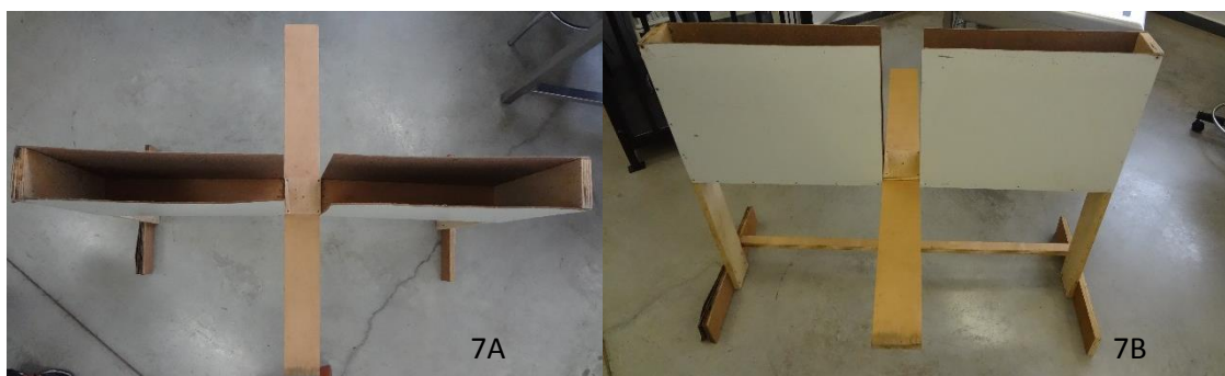
Figura 7A e 7B – Aparato utilizado no teste Labirinto em Cruz Elevado para teste comportamental referente ao parâmetro de ansiedade.
