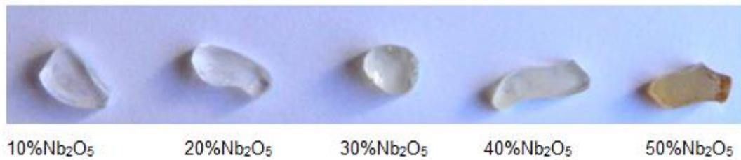
Figura 22- Amostras obtidas no sistema  $\text{KPO}_3\text{-Nb}_2\text{O}_5$ , contendo de 10% a 50% em mol de  $\text{Nb}_2\text{O}_5$ .
