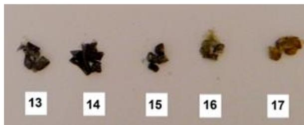
Figura 46- Amostras testadas para a obtenção de vidros transparentes no sistema 40KPO<sub>3</sub>-60WO<sub>3</sub>.
