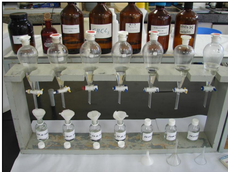
Figura 8 - Sistema de re-extração de urânio. Fonte: Elaborado pelo autor.
