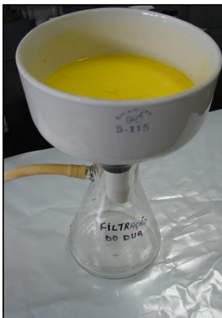
Figura 12 - Filtração do diuranato de amônio. Fonte: Elaborado pelo autor
