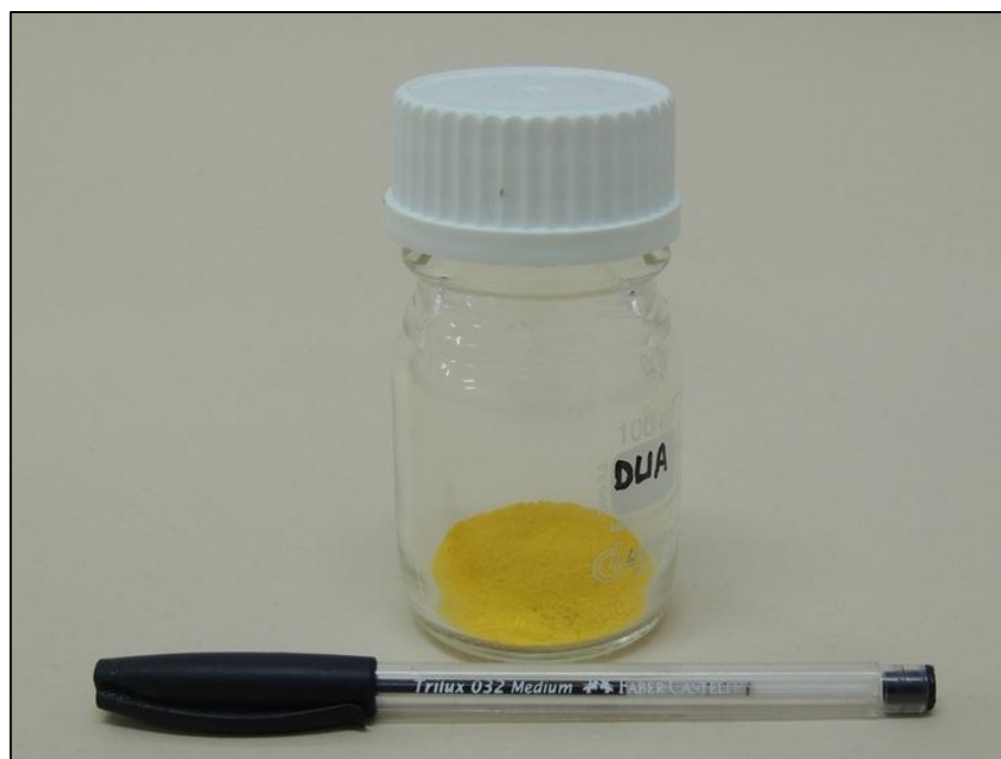
Figura 22 - Diuranato de amônio (DUA)- (\text{NH}_4)_2\text{U}_2\text{O}_7 .
