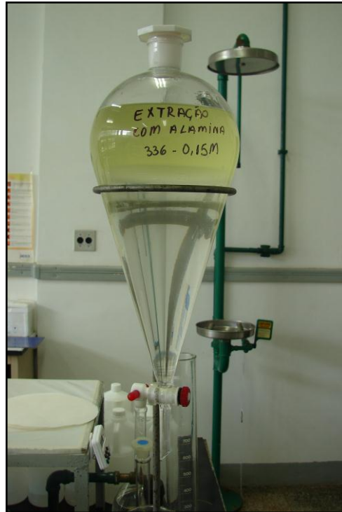
Figura 7 - Sistema de extração de urânio. Fonte: Elaborado pelo autor.
