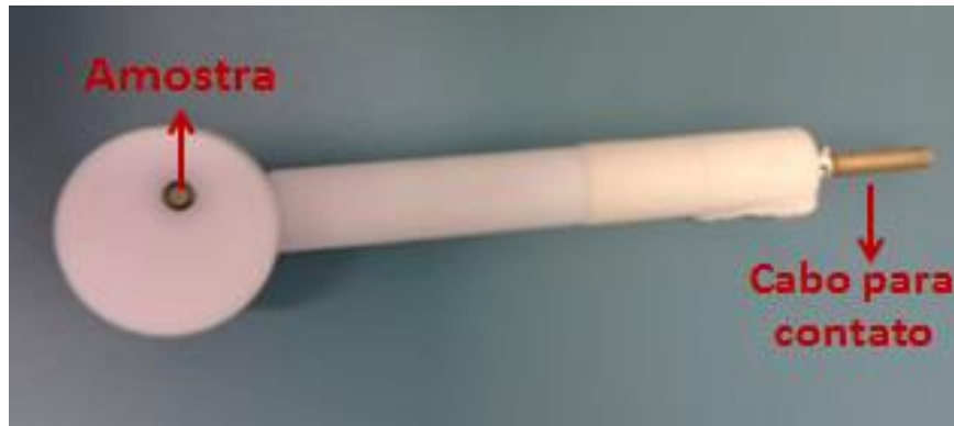
Figura 12 - Suporte de amostra usado como eletrodo de trabalho para ensaio.
