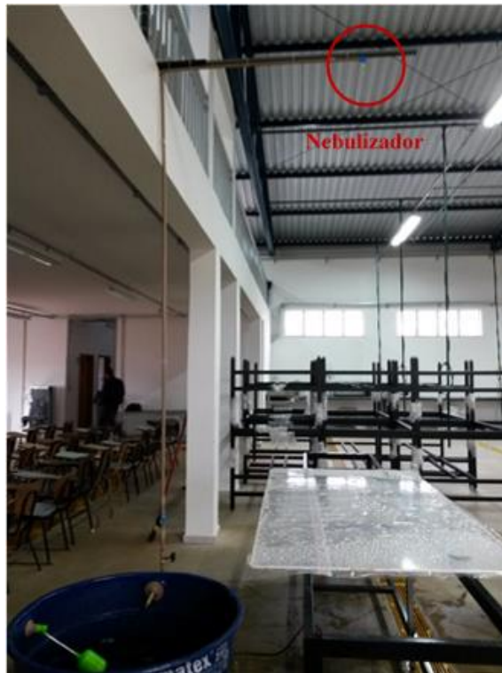
Figura A. 1: Montagem do simulador de chuva com um bocal tipo FullJet® HH- W ¼
