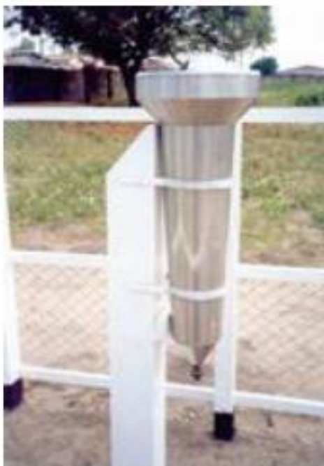
Figura 2.3 - Pluviômetro “Ville de Paris”.
