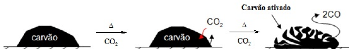
Figura 1 - Esquema representativo da ativação física por CO 2 de uma amostra de carvão.
