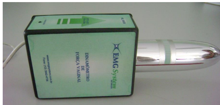
Figura 4 - Dinamômetro vaginal equipado com célula de carga.
