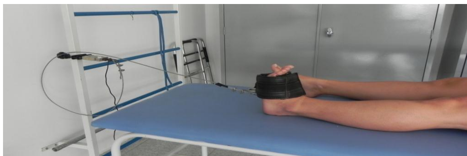
Figura 11 - Posicionamento da voluntária para avaliação da atividade eletromiográfica e pico de torque máximo do músculo tibial anterior.
