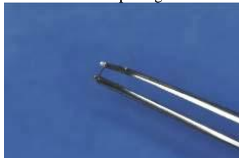
FIGURA 6 - Pinça modificada utilizada para passagem do fio
