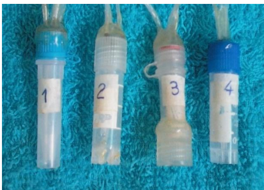
Figura 14 - Fotos dos minireatores testados: 1- 1,7 mL; 2- 2,7 mL; 3-1,5 mL e 4- 2,5 mL.
