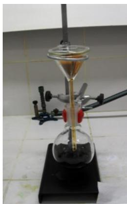
Figura 13 - Ilustração da filtração da solução para retirada do Pd metálico.
