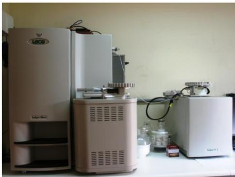
Figura 22 - Equipamento Leco- Truspec Micro CHNS.
