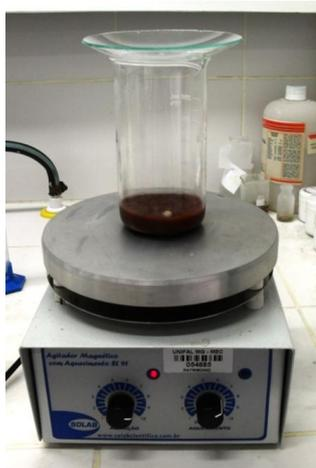
Figura 12 - Ilustração da reação entre  $PdCl_2$  e LiCl
