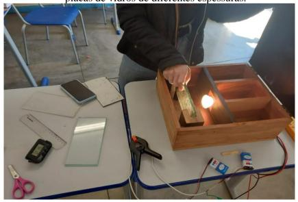
Utilizando um paquímetro, os estudantes aferiram as espessuras das placas de vidro, registrando-as no roteiro e utilizando milímetros como unidade de medida. As placas foram posicionadas separadamente no TFBC, respeitando um intervalo de três minutos entre cada medição. A Figura 38 mostra, com base nos resultados obtidos pelos estudantes, que quanto maior for a espessura do material, maior será a diferença de temperatura, validando assim a intervenção.
