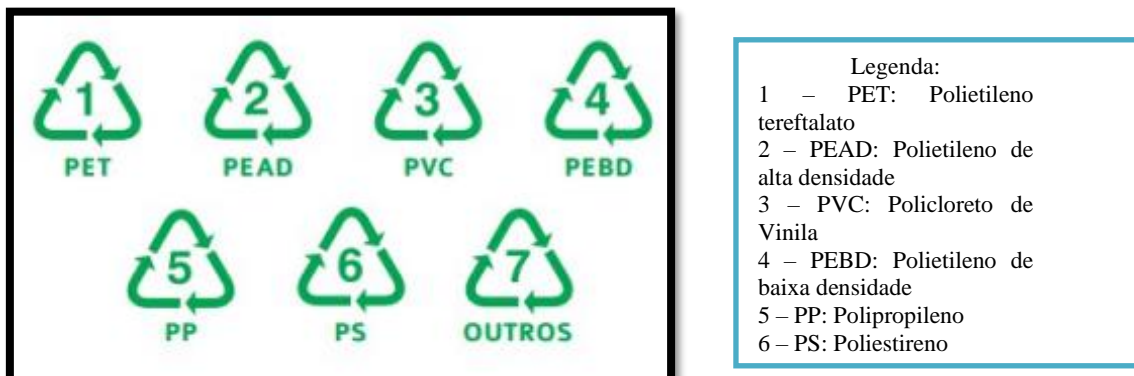
Figura 1 – Símbolos de identificação dos materiais plásticos, segundo a norma ABNT NBR 13230
