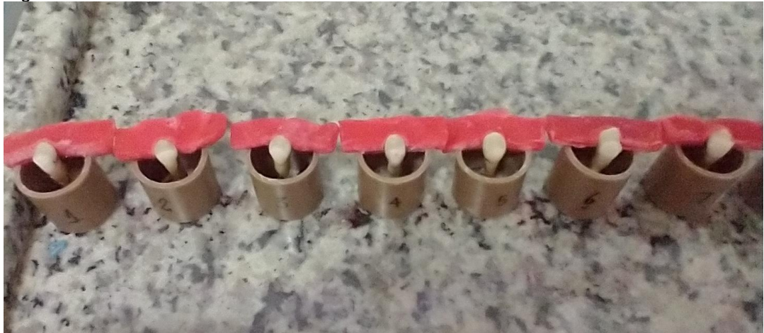
Figura 23 – Dentes fixados aos tubos de PVC.
