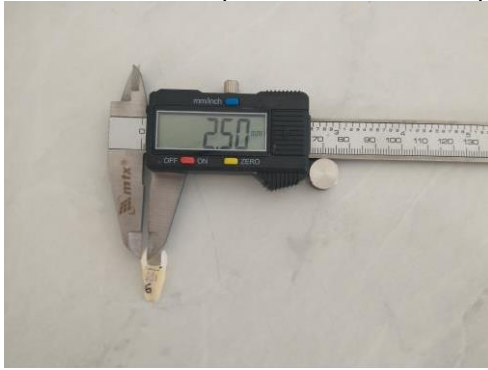
Figura 3 – Medida da parede vestibular, respeitando-se os 2,5mm de espessura.
