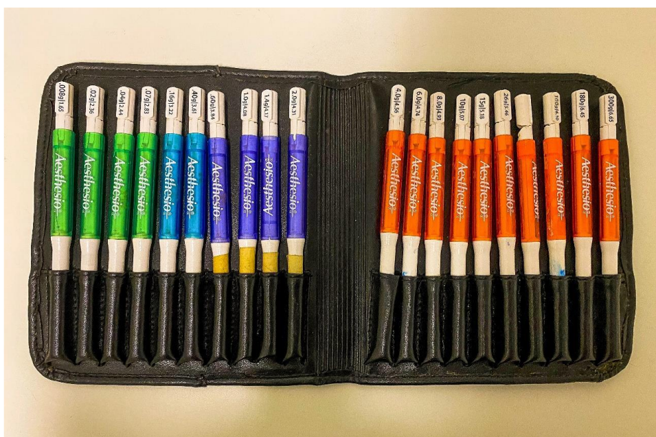
Figura 9 - Kit com os diferentes filamentos utilizado no Teste de von Frey.
