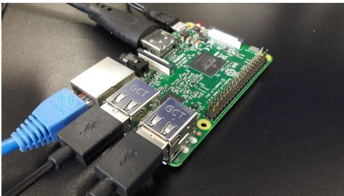
Figura 28 — Raspberry Pi 3 Modelo B como Registrador de Dados
