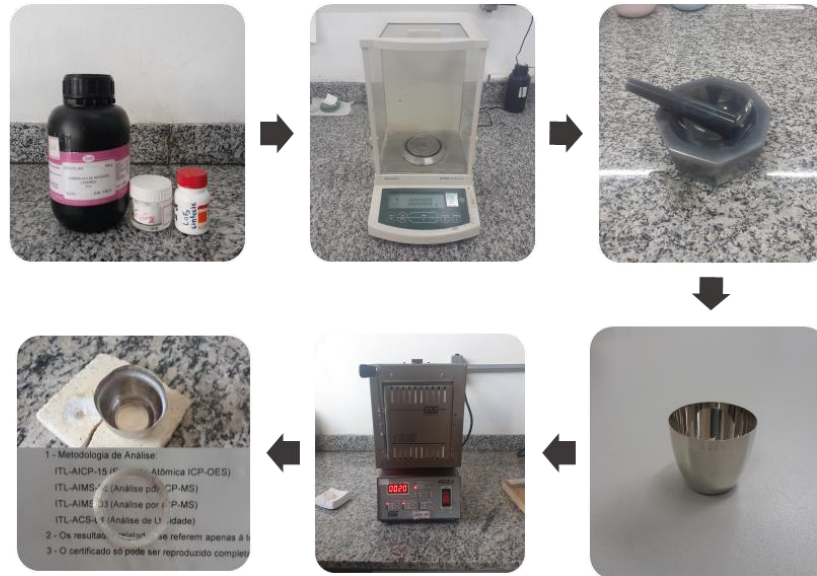
Figura 21 - Fluxograma com fotos das diferentes etapas de preparação das amostras vítreas
