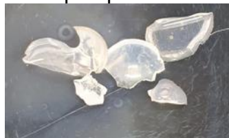
Figura 48 - Amostra 15K30LaTampa após o tratamento térmico de cristalização
