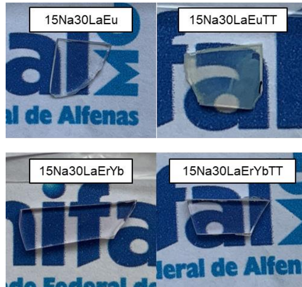
Figura 57 - Amostras do sistema vítreo \text{GeO}_2\text{-Na}_2\text{O-LaF}_3 dopadas e tratadas termicamente
