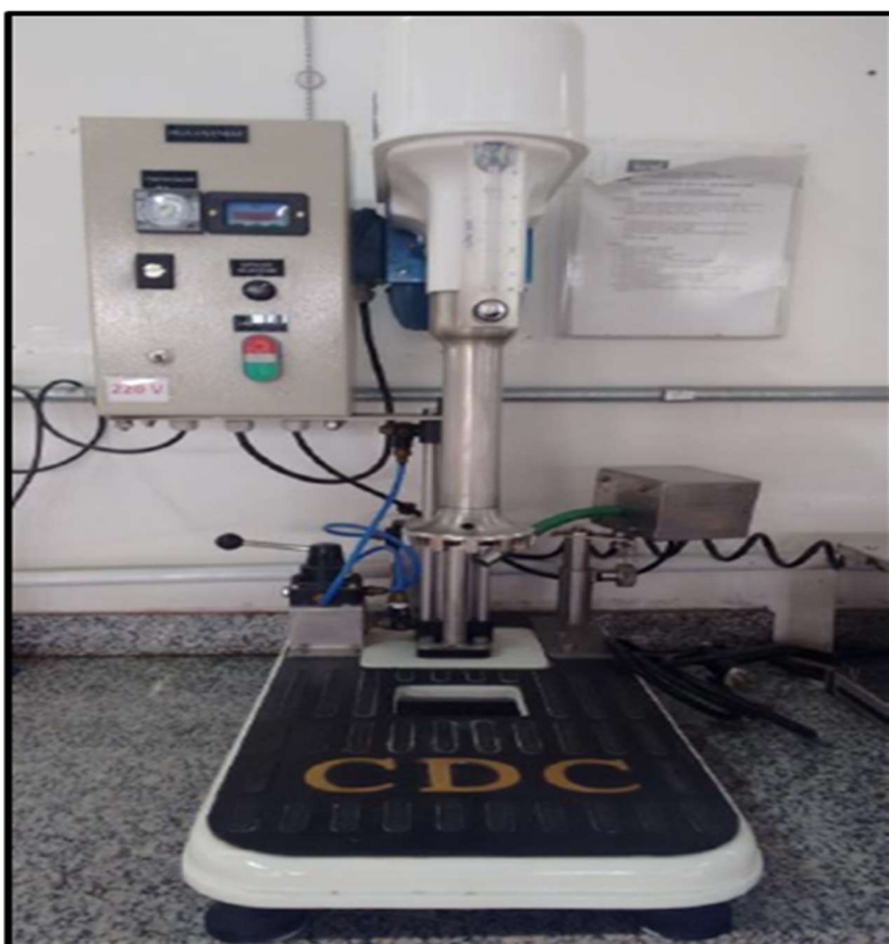
Figura 7- Célula de flotação utilizada na condução dos ensaios de flotação. Fonte: Do autor.
