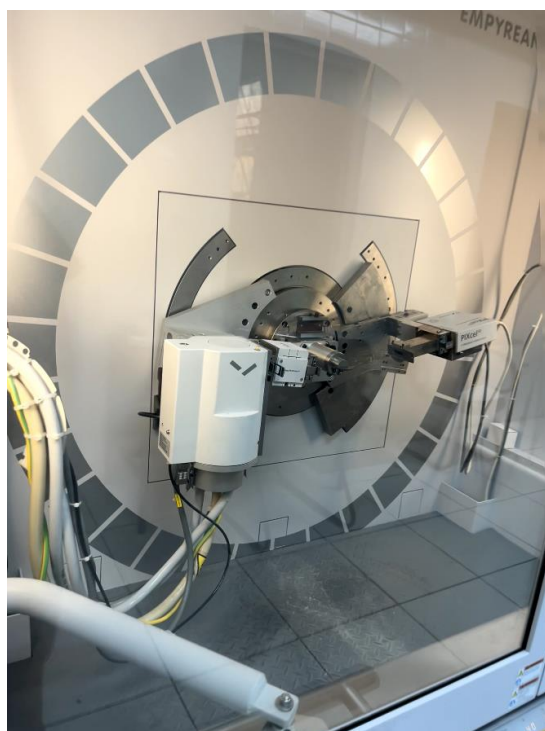
Figura 15 - Detalhe do goniômetro no interior do difratômetro de raios X
