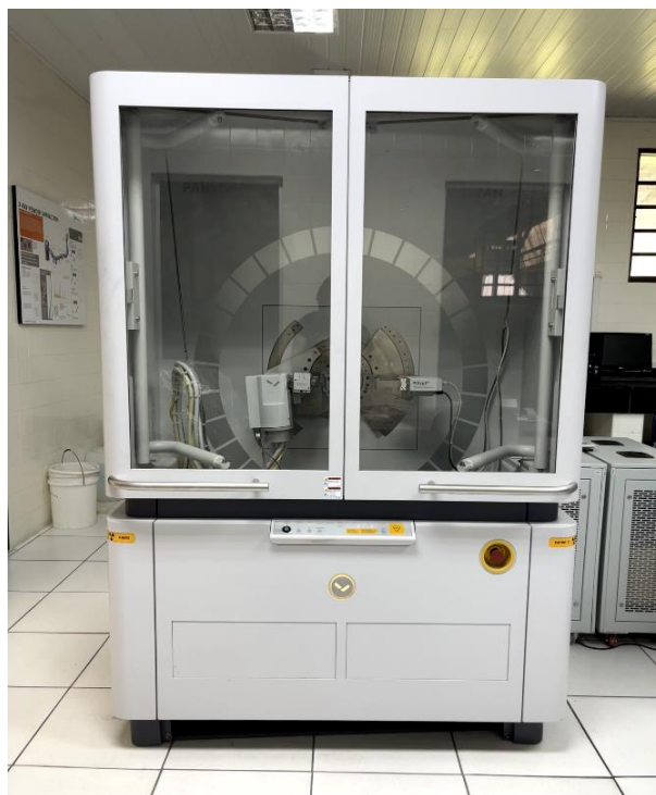
Figura 14 - Difratorômetro de raios X utilizado neste estudo
