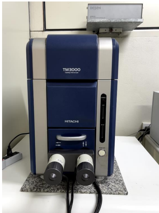
Figura 16 - Microscópio eletrônico de varredura Hitachi TM-3000 com detector de EDS
