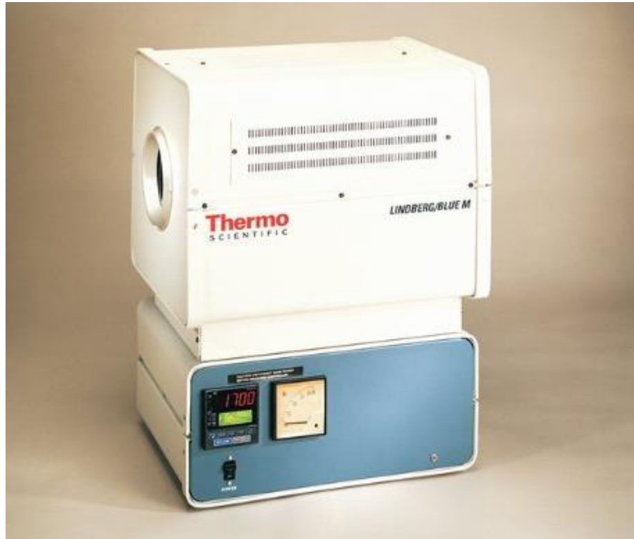
Figura 12 - Forno utilizado para o tratamento térmico por 72 h das cerâmicas de \text{Al}_2\text{O}_3\text{-Y}_2\text{O}_3\text{-Ta}_2\text{O}_5 e pseudo-binárias
