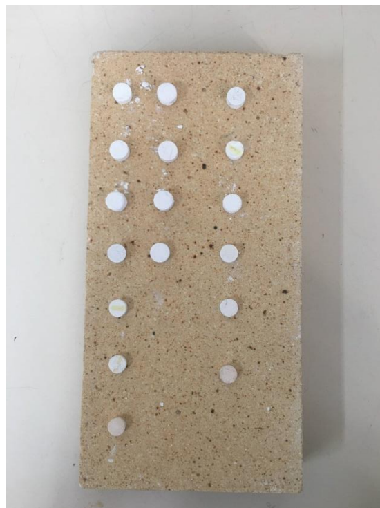
Figura 11 - Pastilhas compactadas das amostras de \text{Al}_2\text{O}_3\text{-Y}_2\text{O}_3\text{-Ta}_2\text{O}_5 avaliadas neste estudo
