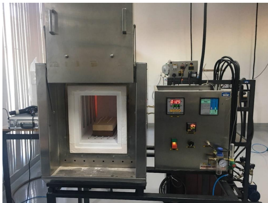
Figura 13 - Forno utilizado para o tratamento térmico adicional de 150 h das cerâmicas de \text{Al}_2\text{O}_3\text{-Y}_2\text{O}_3\text{-Ta}_2\text{O}_5 e pseudo-binárias
