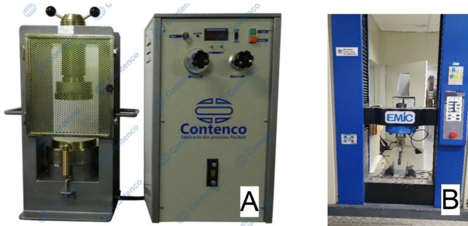
Fonte: (A) Contenco (2023) e (B) Autor (2023). Legenda: (A) Prensa Hidráulica da empresa Contenco/Pavitest 200T I-3025-E e (B) Máquina universal de ensaios EMIC.
