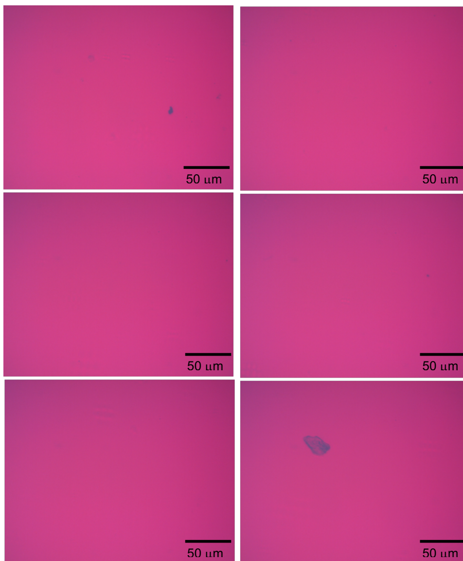
Figura 25 – Imagens de microscópio da superfície do filme com DR13
