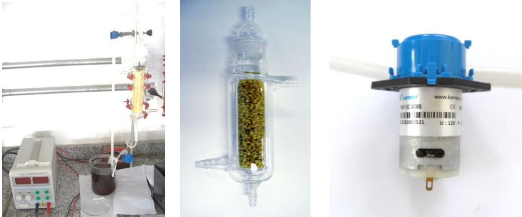
Figura 2 – Esquema experimental utilizado, coluna de vidro e bomba peristáltica Kamoer – modelo 12V
