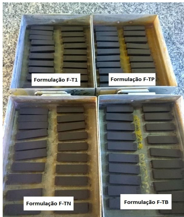
Figura 12 - Corpos de prova cerâmicos preparados a partir das matérias-primas tratadas e sem tratamento, da primeira etapa.
