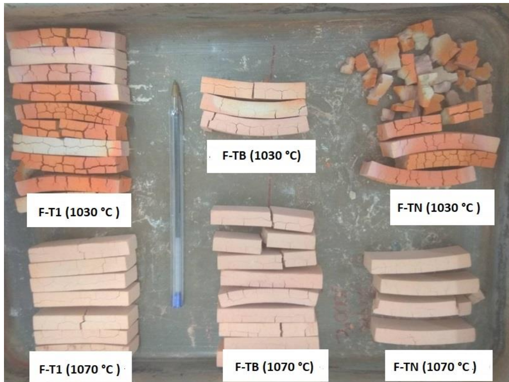
Figura 13 - Corpos de prova sinterizados a 1030 °C e 1070 °C.
