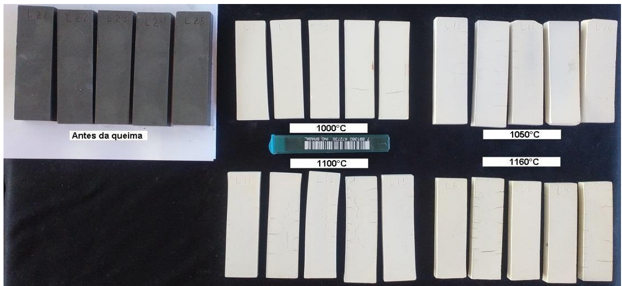
Figura 27 - Resultados da sinterização da formulação F-TP2-S.
