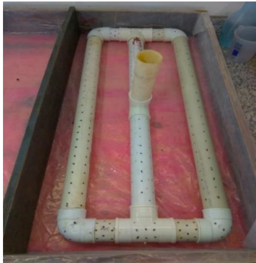
Figura 4 - Aparato desenvolvido em cano PVC, para armazenar os dejetos bovino.
