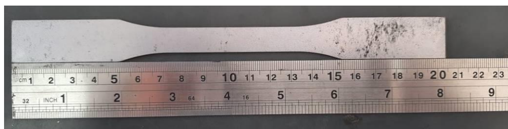
Figura 20 - Corpo de Prova com deformação de 2%
