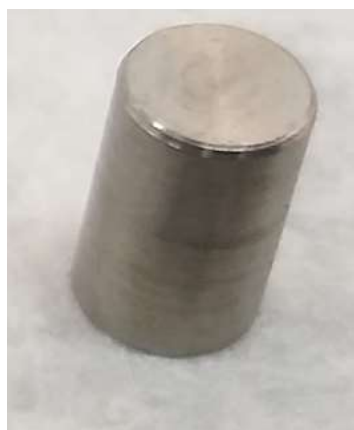
Figura 7 –Corpo de prova da amostra de 91Ti-6Si-3B, tratados termicamente
