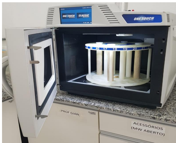
Figura 10 – Rotor balanceado acoplado a cavidade do aparelho micro-ondas
