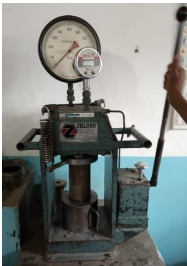
Figura 19 - Rompimento de corpo-de-prova por compressão em Prensa Hidráulica Manual
