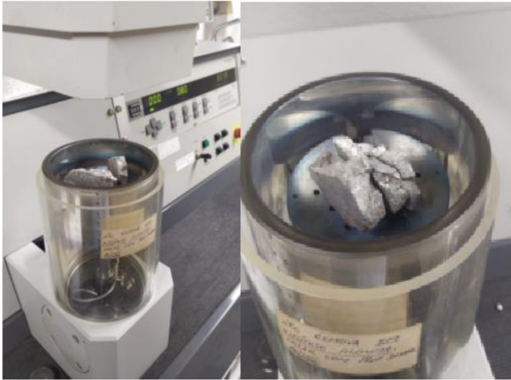
Figura 24 - Metalização das Amostras de Concreto
