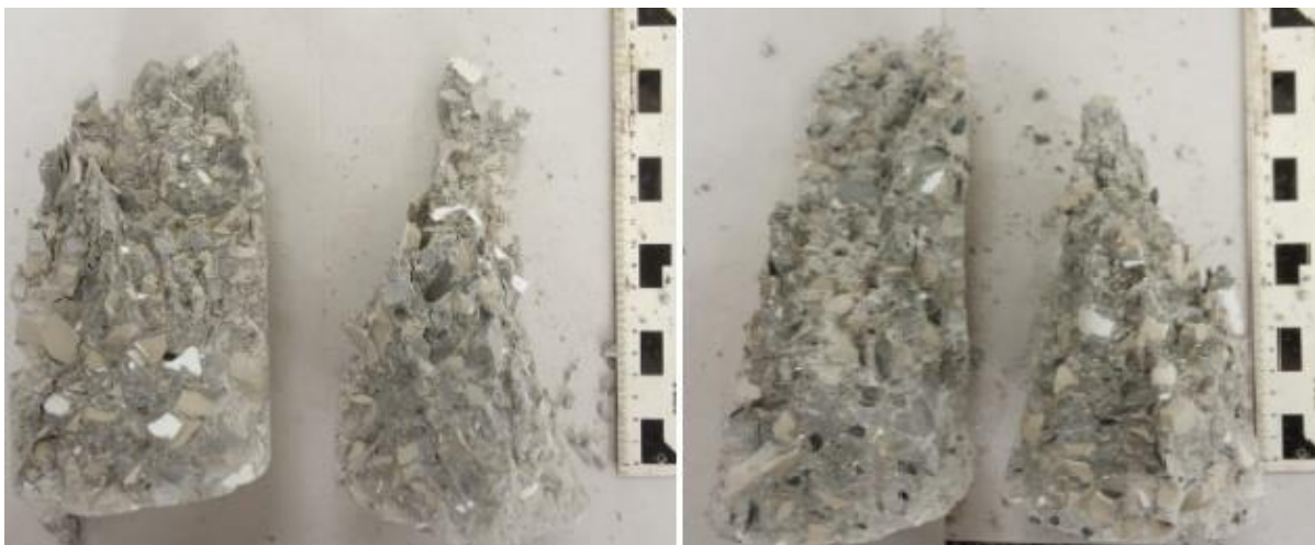
Figura 42 - Interior dos Corpos-de-prova C75, Após Rompimento em Máquina de Ensaio
