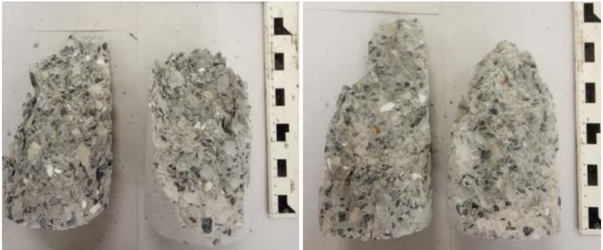
Figura 40 - Interior dos Corpos-de-prova C25, Após Rompimento em Máquina de Ensaio
