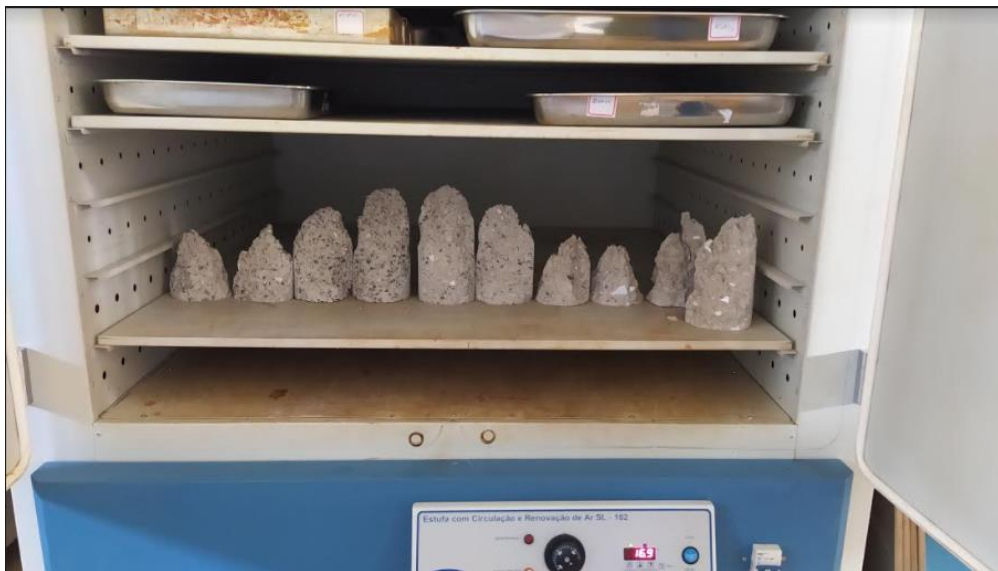
Figura 21 - Corpos-de-prova Rompidos Posicionados no Interior da Estufa
