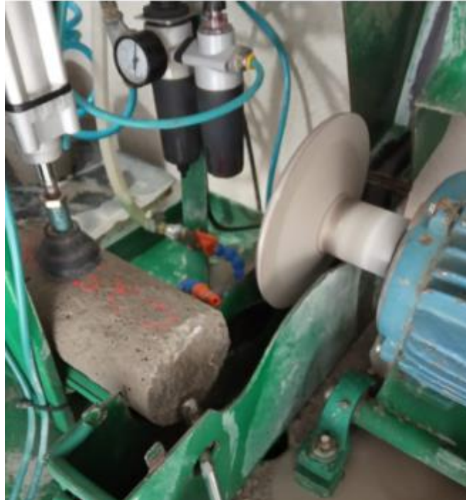
Figura 17 - Corpo-de-prova sendo retificado
