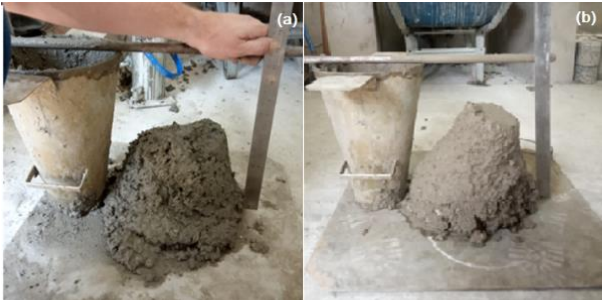
Figura 16 - Slump Test realizado
