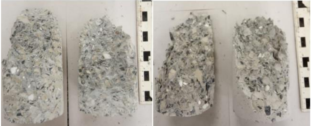
Figura 41 - Interior dos Corpos-de-prova C50, Após Rompimento em Máquina de Ensaio
