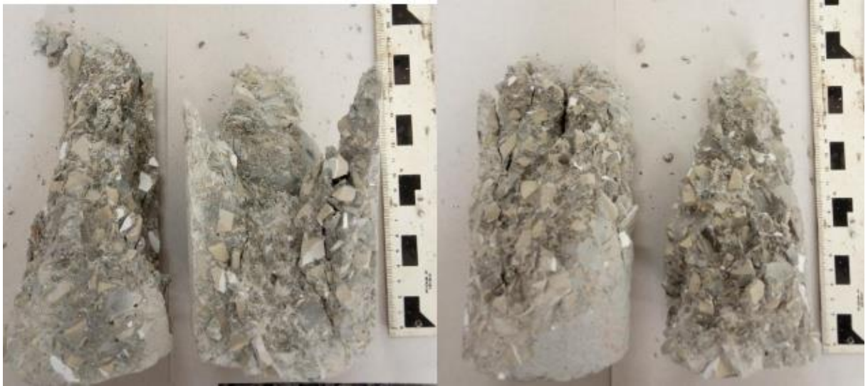
Figura 43 - Interior dos Corpos-de-prova C100, Após Rompimento em Máquina de Ensaio
