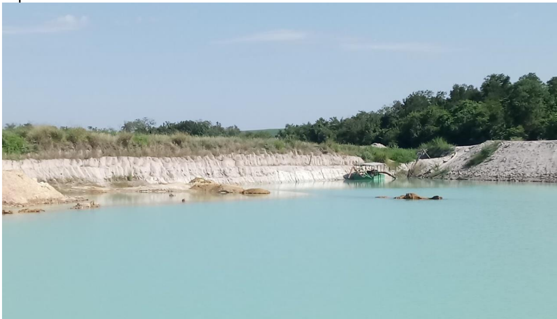
Figura 13 - Presença de uma draga que retira a água da mina e transfere para a represa
