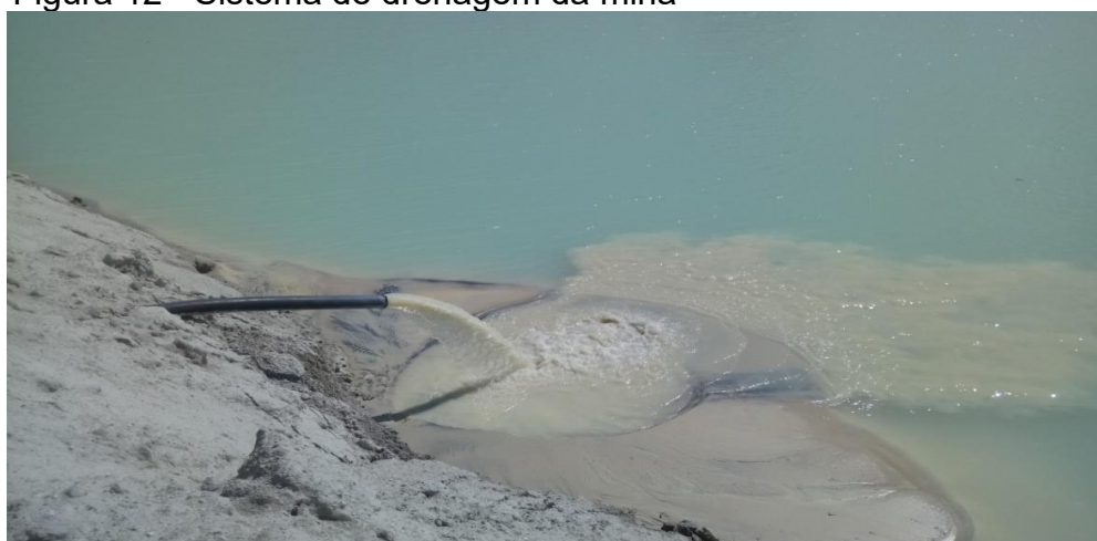
Figura 12 - Sistema de drenagem da mina
