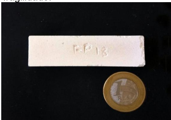
Figura 59 - FP com extremidade lascada devido à fragilidade.
