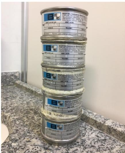
Figura 5- Sistema de peneiras com diferentes granulometria.
