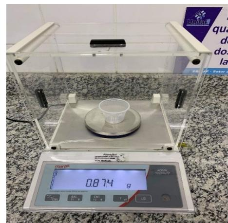
Figura 9- Balança de precisão
