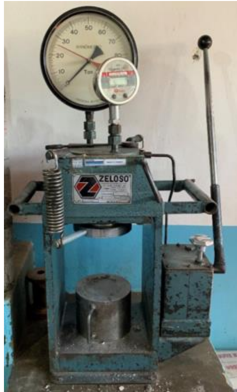
Figura 10 - Prensa utilizada para os ensaios de compressão.
