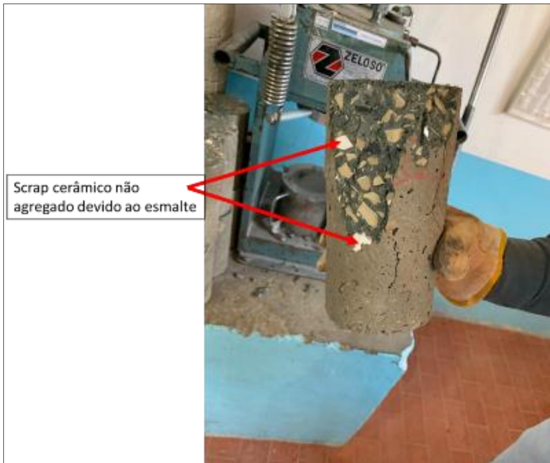
Figura 17 - Corpo de prova após rompimento com 28 dias CP-75
