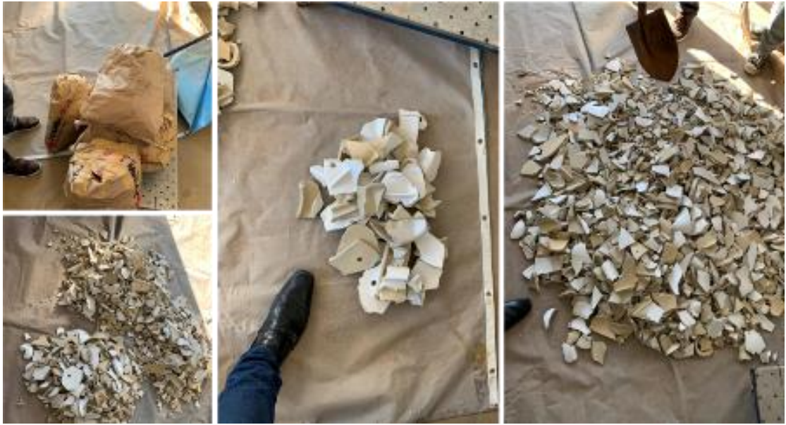
Figura 3 - Scrap na composição original, em cacos de variados tamanhos e formatos
