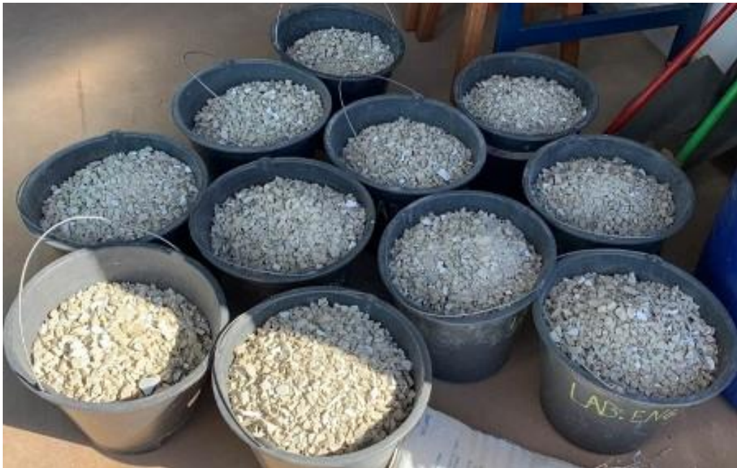
Figura 4 - Scrap após a britagem obtendo a homogeneidade esperada
