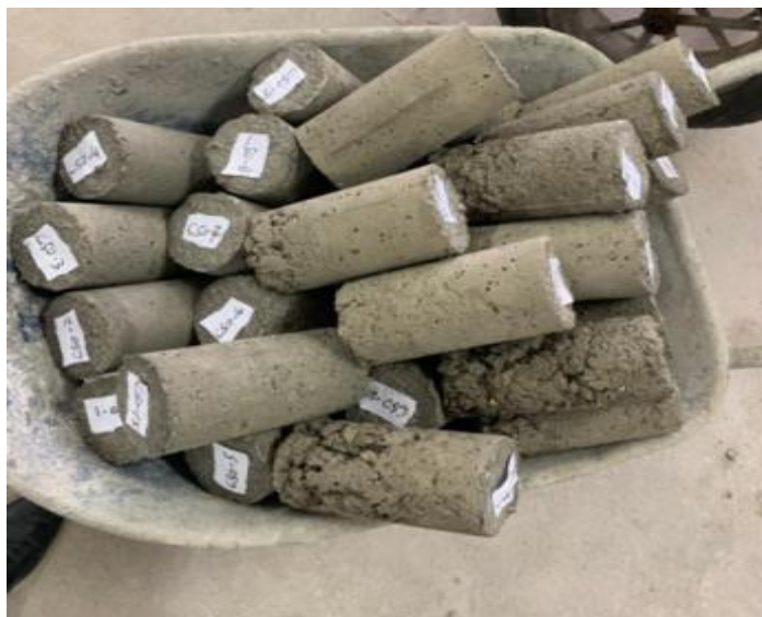
Figura 18 - Lote CP-50 descartado, muito poroso e pouco adensado
