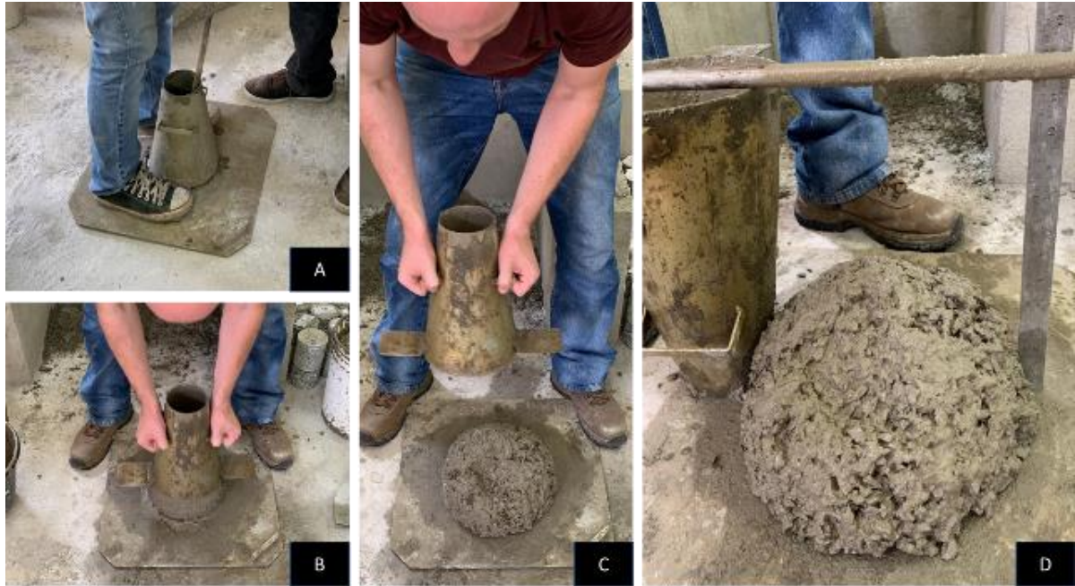
Figura 7 – Execução do teste de SLUMP
