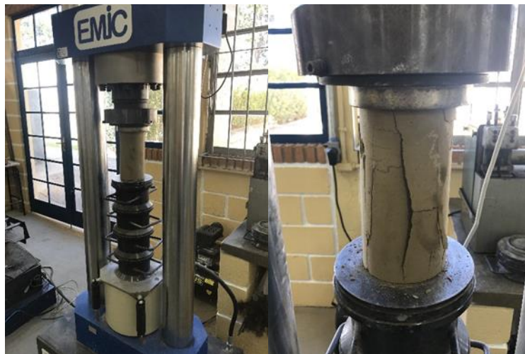
Figura 9- Ensaio de resistência mecânica dos corpos de prova confeccionados
