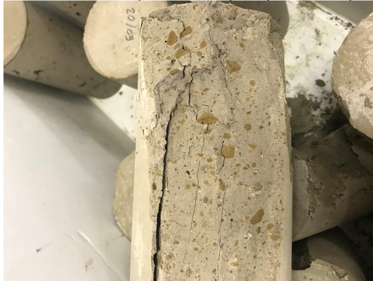
Figura 2- “Bolhas de resíduo” presentes nos corpos de prova com composição C9
