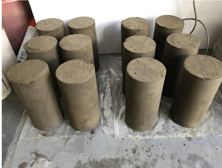
Figura 8- Corpos de prova prontos para o ensaio de resistência mecânica
