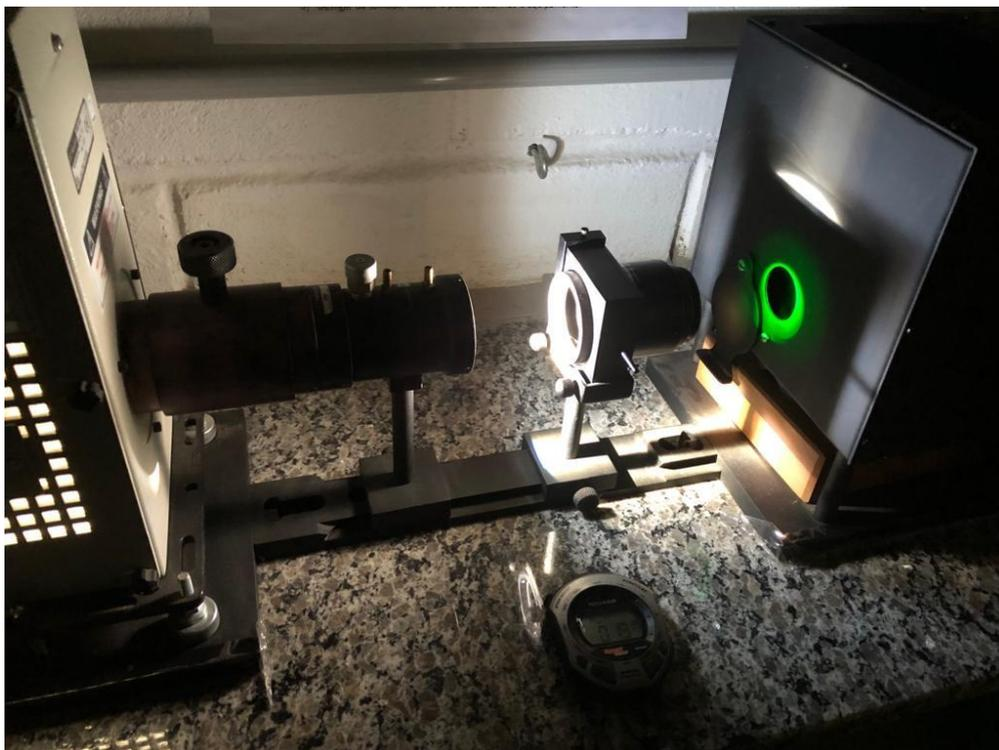
Figura 56 - Trem óptico utilizado na fotólise contínua da mistura do complexo  $[\text{bis-RuCl}(5,5'\text{-Mebipy})_2\text{-}\mu\text{-Ru}(\text{pyterpy})_2](\text{PF}_6)_4$  com  $\text{MV}(\text{PF}_6)_2$  em  $\text{CH}_3\text{CN}$ .
