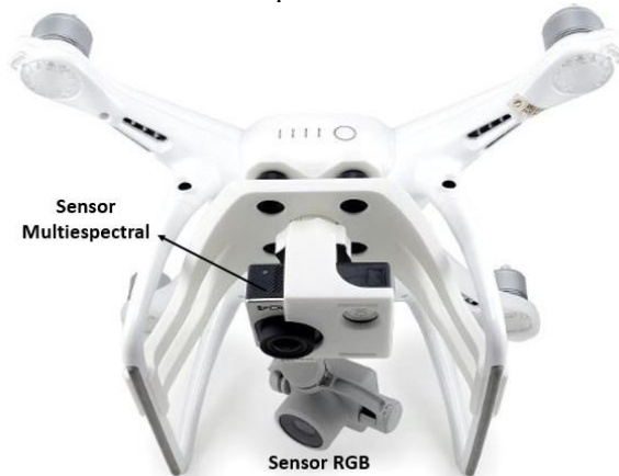
Figura 8 - RPA DJI Phantom 4 com sensor multiespectral extra embarcado.
