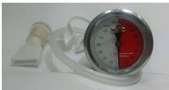
Figura 6 – Manovacuômetro analógico com bocal.
