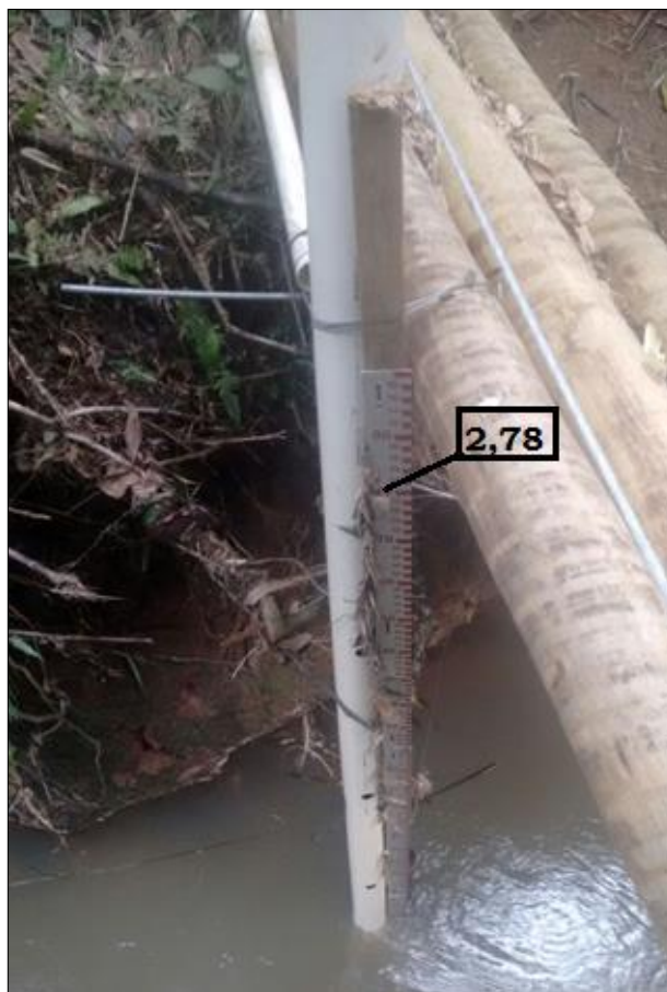
Figura 18 – Evidência da cheia registrada pelo sensor no dia 10/03/2018.
