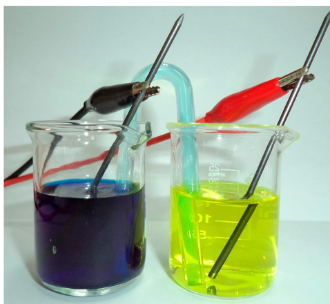
Figura 17 - Montagem da MFC, mostrando as câmaras anódica (esquerda) e catódica (direita), preenchidas com seus respectivos eletrólitos.
