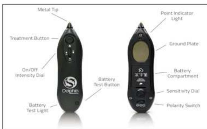
Figura 11 – Dispositivo de Microcorrente – Dolphin Neurostim
