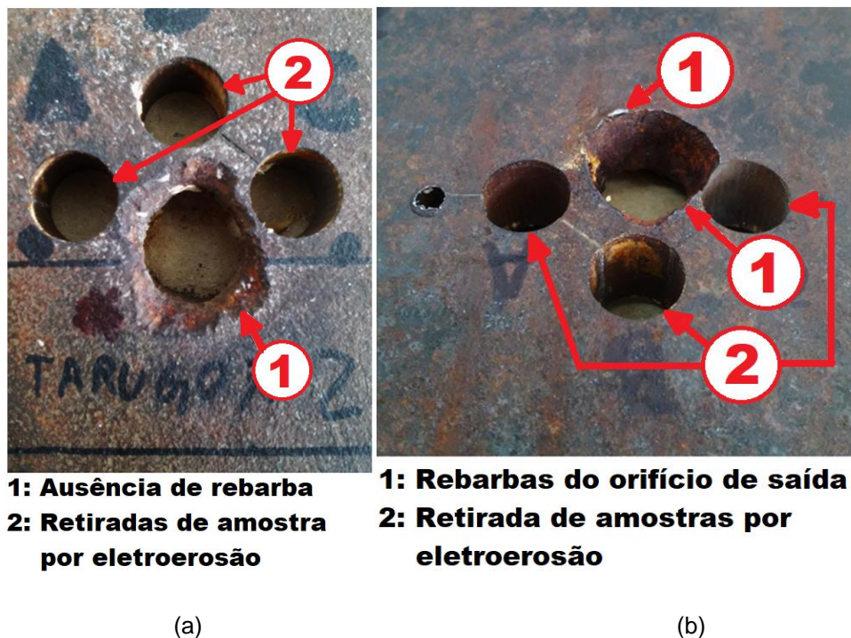
Figura 27 - Região de perfuração completa (PC). (a) Evidenciando estilhaçamento nas bordas da perfuração. (b) Evidenciando rebarbas.
