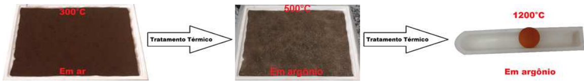
Figura 26 – Imagens ilustrando os aspectos para o do puff obtido com tratamento térmico da resina em 300°C em ar (a esquerda), para o tratamento térmico em 500°C em argônio (ao centro) e tratamento térmico da amostra na forma de pastilha entre 900 a 1200°C em atmosfera de argônio (a direita).
