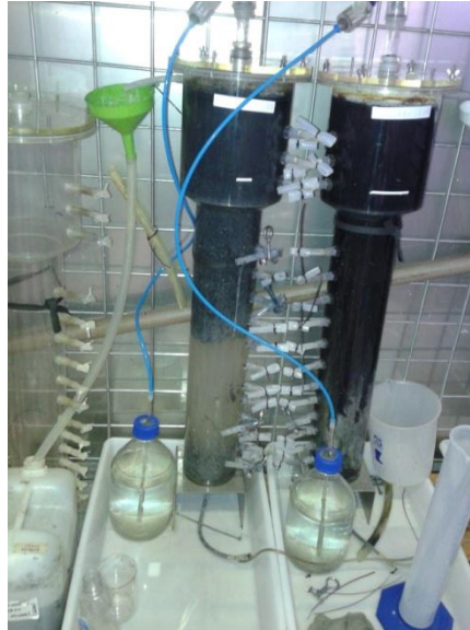
Figura 27 - Flotação de lodo no reator alimentado com soro de leite.
