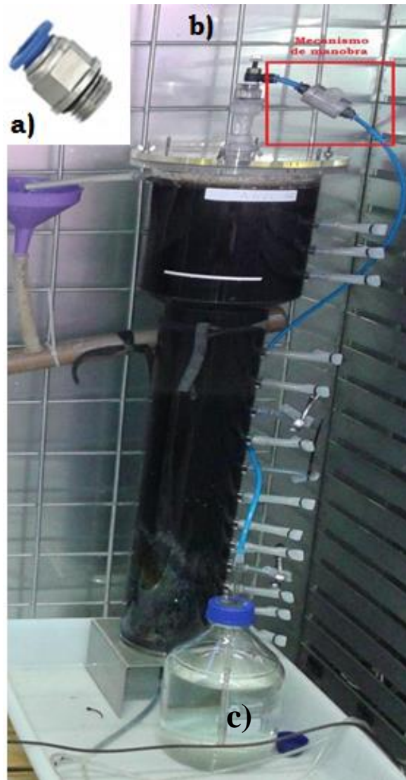
Figura 10 - Melhorias realizadas no sistema a) conexão de engate rápido, b) mecanismo de manobra dos reatores, c) selo hídrico.
