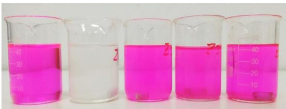
Figura 84 - Representação das amostras depois de completada a reação de fotocatalise em 120 minutos. Da esquerda para direita: Branco, ZnO P, Z1, Z2 e Z3.
