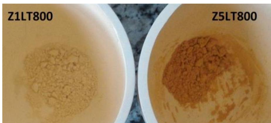
Figura 87 - Ilustração da coloração das amostras Z1LT800 e Z5LT800 após a queima realizada a 800°C.
