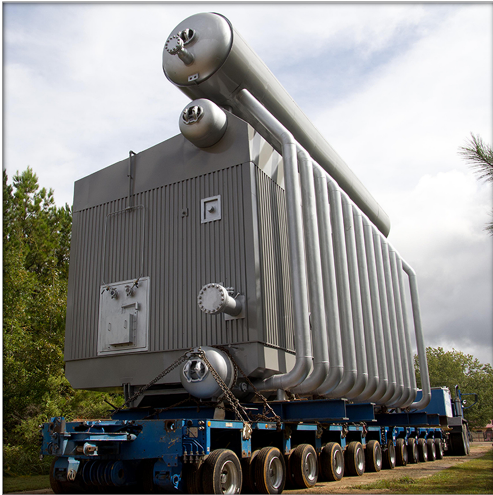
Figura 13 - Caldeira aquatubular sendo transportada. Fonte: Adaptado de (BABCOCK, 2017).
