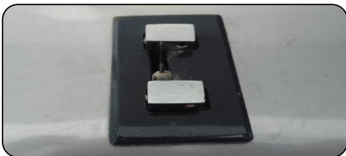
Figura 3 – Filamento de níquel-cromo
